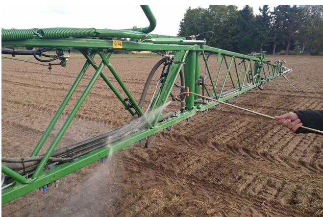
Reinigung des Gestänges auf der Behandlungsfläche Foto: Michael Glaser/LTZ
