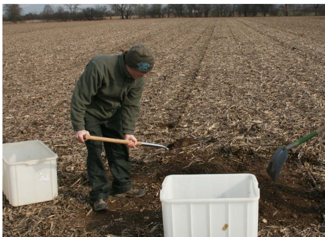
Entnahme von Bodenproben auf einem abgeernteten Maisacker Foto: Franz-Josef Kansy/LTZ
