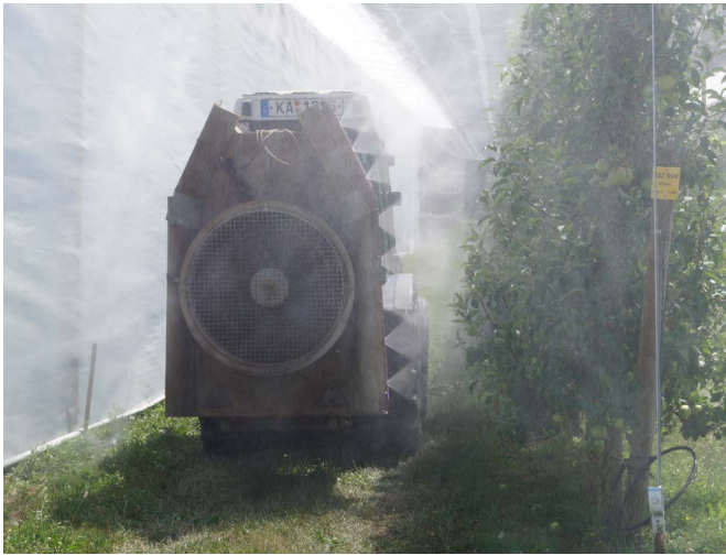
Abdriftversuch in einer Apfelanlage am LTZ Augustenberg Foto: Jörg Jenrich/LTZ
