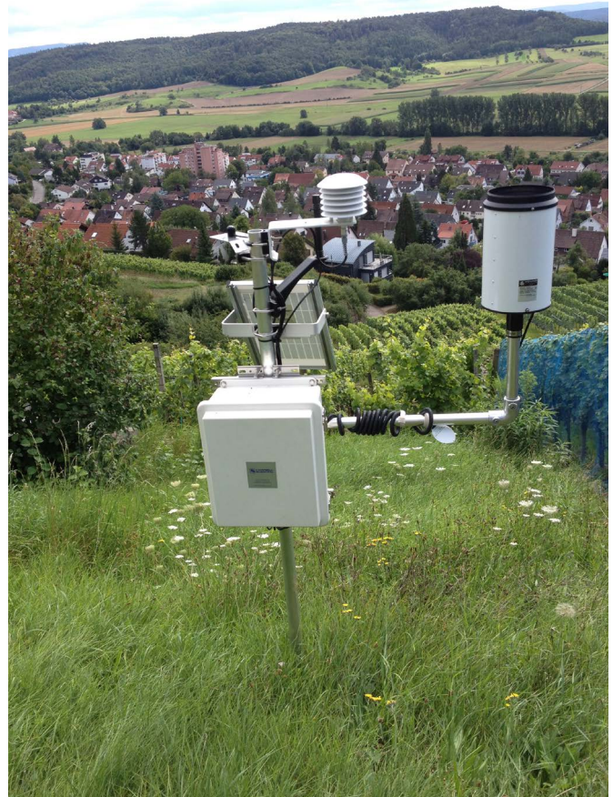
Wetterstation des landeseigenen Wetterstationsnetzes in Baden-Württemberg Foto: Helge de Boer/LTZ
