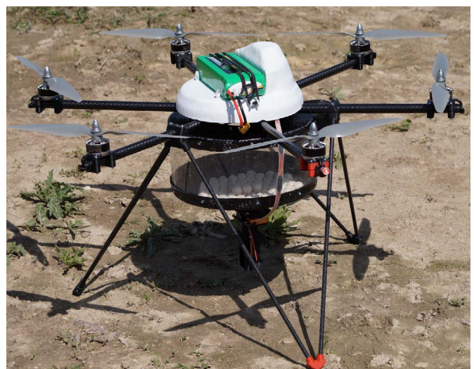
Mit einem Multikopter werden Trichogramma-Kugeln in den Maisbestand ausgebracht.
